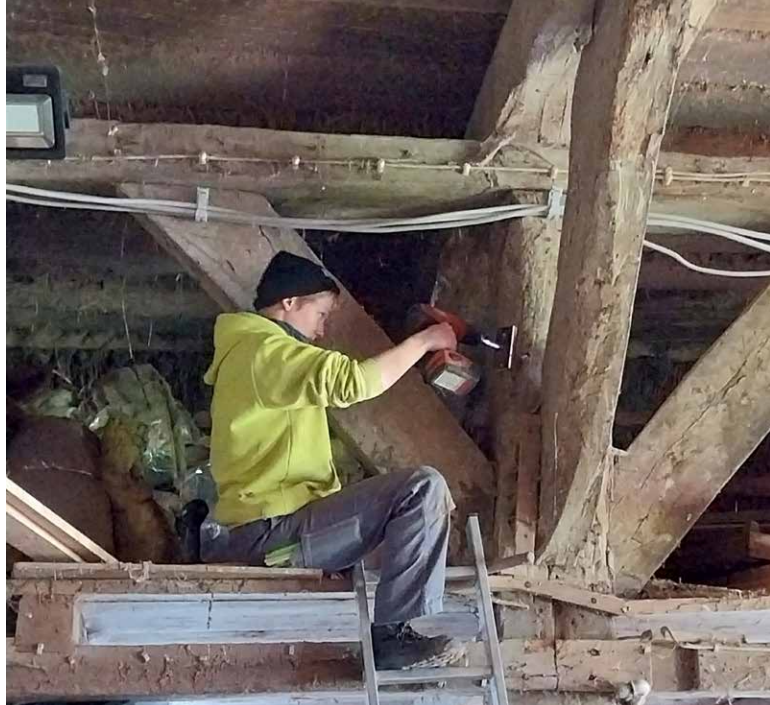
Dendrochronologische Probenentnahme im Fachhallenhaus in den Elbmarschen
